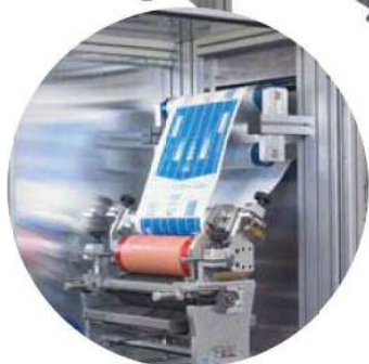
オプションのATEXゾーン内のコーティングステーション
